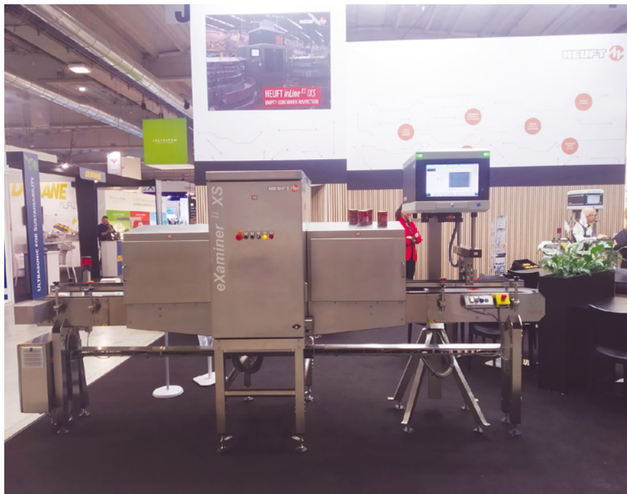
Il sistema di ispezione compatto eXaminer ® XS (Heuft).
