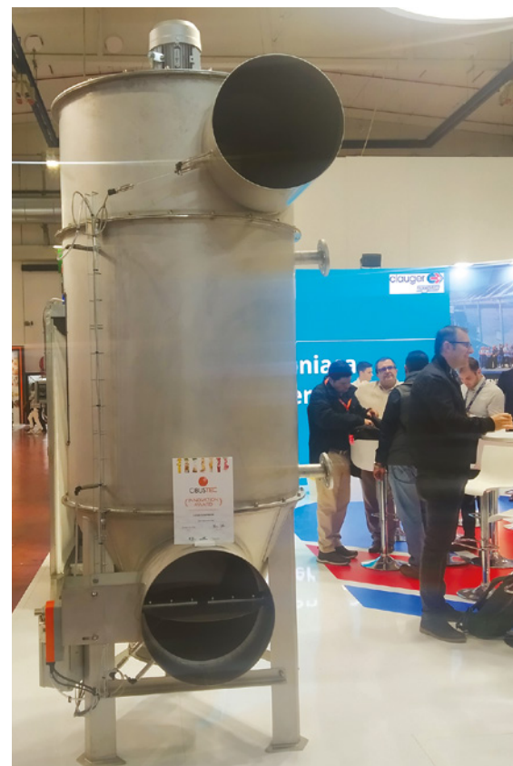
Skid di recupero del calore (Clauger-Technofrigo).
