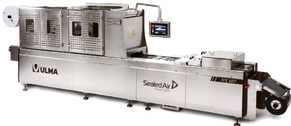
Termoformatrice skin TFS 507 (Ulma).
